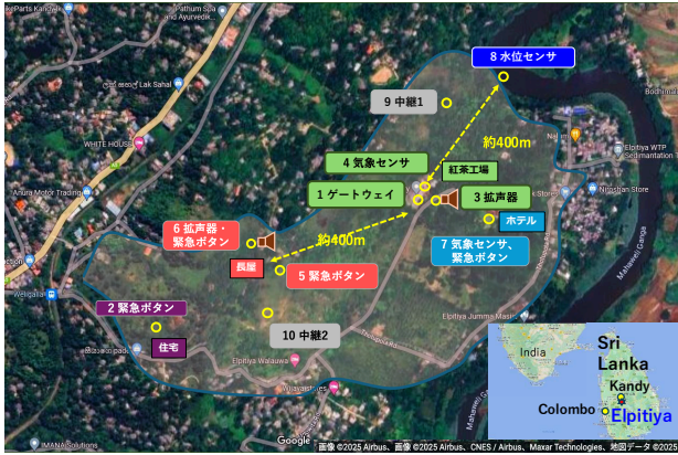
図 5 実証エリアと機器の設置位置
