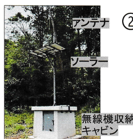
<紅茶工場内の環境監視センサー(左) 河川水位データの送信設備(右)>
